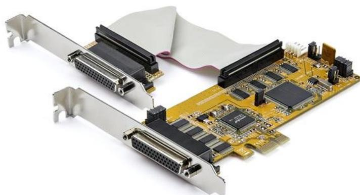
Consente di aggiungere otto porte seriali RS-232 DB9 a un computer desktop tramite due slot per schede di espansione PCIe. Dotata di due cavi breakout, questa scheda PCI express seriale fornisce numerose porte per collegare un'ampia varietà di periferiche seriali a velocità fino a 921,4 Kbps.
